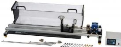
Lessai de torsion fait partie des méthodes dessai destructif, et étudie le comportement plastique des matériaux. Dans la pratique, on se sert de cette méthode dessai pour tester des composants qui sont tordus pendant leur utilisation, comme par exemple les vis, arbres, axes, fils et ressorts.
