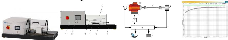
Lessai de torsion fait partie des méthodes dessai destructif, et étudie le comportement plastique des matériaux. Dans la pratique, on se sert de cette méthode dessai pour tester des composants qui sont tordus pendant leur utilisation, comme par exemple les vis, arbres, axes, fils et ressorts.
