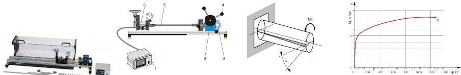
L'essai de torsion fait partie des méthodes d'essai destructif, et étudie le comportement plastique des matériaux.
