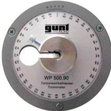
**WP 500.90 Instrument de mesure de l'angle de torsion
