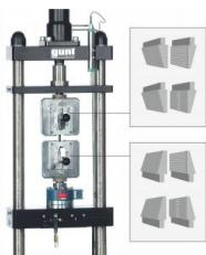
Cet accessoire, conçu pour l'appareil dessai WP 310, permet de réaliser des essais de traction sur des éprouvettes plats ou ronds.
