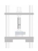
Cet accessoire, conçu pour lappareil dessai WP 310, permet de réaliser un essai de ressort à laide dun ressort à disques.
