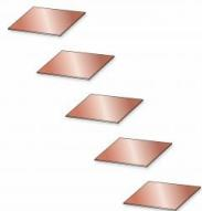
Ce jeu d'échantillons métalliques est disponible comme accessoire pour la machine d'essai universelle WP 300. Les échantillons sont de forme carrée et sont prévus pour la réalisation d'essais d'emboutissage.
