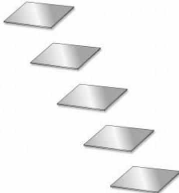
Ce jeu d'échantillons métalliques est disponible comme accessoire pour la machine d'essai universelle WP 300. Les échantillons sont de forme carrée et sont prévus pour la réalisation d'essais d'emboutissage. Le jeu comprend cinq échantillons en acier.
