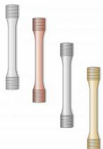
Ce jeu d'éprouvettes est disponible en accessoire pour l'appareil d'essai WP 300.
