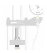
Cet accessoire, conçu pour l'appareil d'essai WP 300, permet de réaliser un essai de ressort à l'aide d'un ressort à disques.
