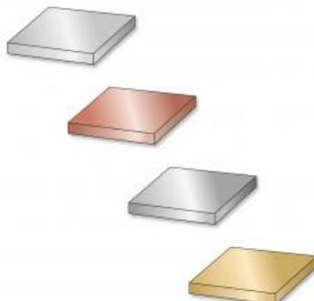
WP 300.03 4 Eprouvettes pour essai dureté Brinell, aluminium, cuivre, laiton (Réf. 020.300)
