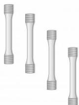
Ce jeu d'éprouvettes est disponible en accessoire pour l'appareil d'essai WP 300.
