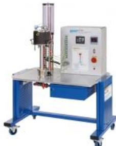
**WL 900 Banc d'essai de conductivité thermique linéaires de divers éprouvettes (Réf. 060.90000)**
