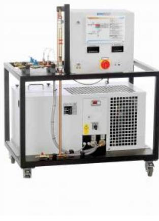
La fonction principale du WL 312.11 est de fournir un circuit deau froide pour les essais dans le WL 312 et le WL 315C. L'alimentation en eau froide permet de assurer un bon fonctionnement lorsque la température ambiante et celle de leau sont élevées.
