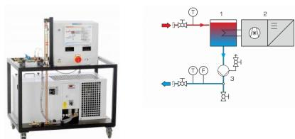
La fonction principale du WL 312.11 est de fournir un circuit deau froide pour les essais dans le WL 312 et le WL 315C. L'alimentation en eau froide permet de assurer un bon fonctionnement lorsque la température ambiante et celle de leau sont élevées.
