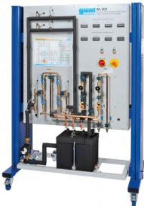
Le banc d'essai mobile permet d'étudier les propriétés caractéristiques d'un échangeur de chaleur tubulaire. L'échange de chaleur a lieu dans un échangeur à tubes coaxiaux, l'eau chaude étant envoyée à travers le tube intérieur.
