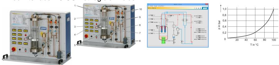
La vapeur se condense lorsqu'elle entre en contact avec un fluide dont la température est inférieure à la température de saturation de la pression partielle de la vapeur présente.
