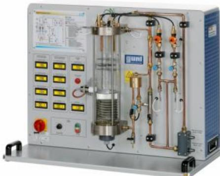
La vapeur se condense lorsqu'elle entre en contact avec un fluide dont la température est inférieure à la température de saturation de la pression partielle de la vapeur présente.
