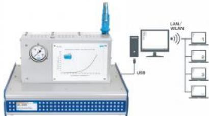
Dans un système fermé avec remplissage de liquide, un équilibre thermodynamique s'établit entre le liquide et sa phase à l'état de vapeur.
