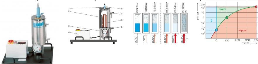
Dans un système fermé avec remplissage de liquide, un équilibre thermodynamique s'établit entre le liquide et sa phase à l'état de vapeur.
