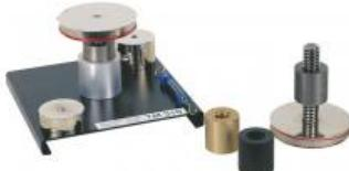
L'appareil de base est constitué pour l'essentiel d'un couplage broche filetée - écrou en position verticale. Un couple est exercé sur une broche par le biais d'une poulie, à l'aide d'une balance à ressort et d'un câble. Des poids additionnels sur le plateau rotatif influent sur la charge axiale du fillet.
