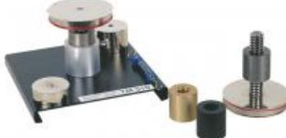
L'appareil de base est constitué pour l'essentiel d'un couplage broche filetée - écrou en position verticale. Un couple est exercé sur une broche par le biais d'une poulie, à l'aide de la balance à ressort et du câble. Des poids additionnels sur le plateau rotatif influent sur la charge axiale du filet.
