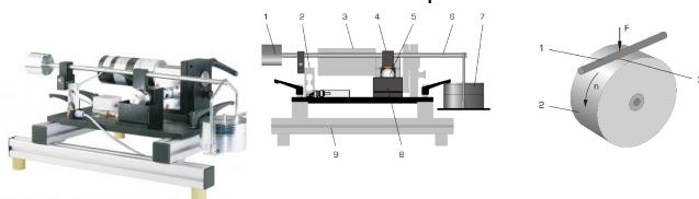
En technique de palier et d entraînement, des frottements dynamiques apparaissent aux endroits de glissement et de roulement, qui entraînent des pertes de performance des systèmes techniques.
