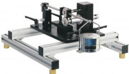
En technique de palier et d'entraînement, des frottements dynamiques apparaissent aux endroits de glissement et de roulement, et entraînent des pertes de performance des systèmes techniques.
