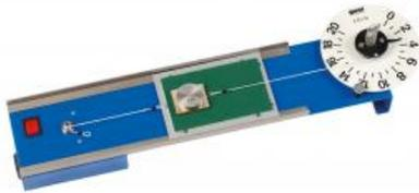
L'appareil permet d'effectuer des essais de base sur le frottement d'adhérence et le frottement de glissement.
