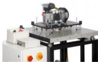
Un compresseur à piston est typique une machine sur laquelle les balourds et les masses oscillantes génèrent des vibrations.
