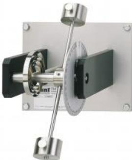
Sur les ressorts de type spiral, la force de rappel est produite par la déformation élastique d'une bande métallique en forme de spirale d'Archimède.
