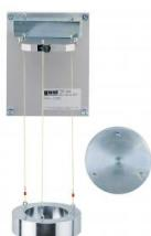
Sur une suspension bifilaire, un corps de pendule est suspendu à deux fils.
