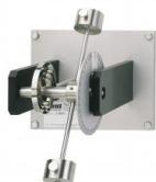
Sur les ressorts de type spiral, la force de rappel est produite par la déformation élastique d'une bande métallique en forme de spirale d'Archimède.
