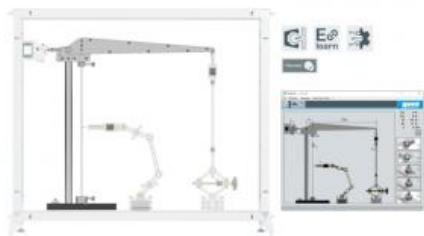
Les colonnes et les supports sont utilisés comme structures porteuses dans les constructions ou les machines. La conception et le contrôle des structures porteuses comprennent non seulement la force de compression à absorber, mais aussi la stabilité.
