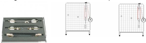
Le jeu complémentaire TM 110.02 élargit la gamme des essais du TM 110 avec le sujet comparaison de différentes poules et de leurs effets en tant que "machines simples".
