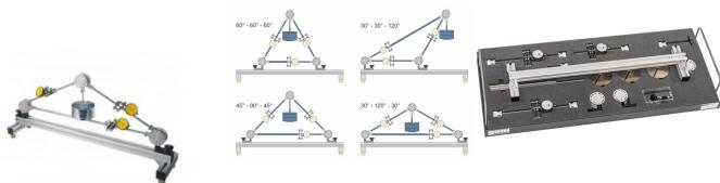
Le FL 111 représente un treillis idéal. Dans le système plan, les barres sont soumises uniquement à la compression et à la traction.
