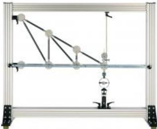
On observe une déformation élastique d'un composant lorsque celui-ci est soumis à une charge. Ces déformations peuvent être calculées en déterminant p. ex. les courbes de flexion élastique. Les courbes de flexion élastique décrivent la déformation de l'ensemble du composant sous forme d'équation mathématique.
