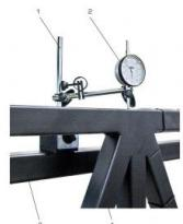
Ce jeu de comparateurs mécaniques à cadran permet de mesurer précisément les distances mécaniques. Il sert également à mesurer le fléchissement, les déplacements ainsi que les distances.
