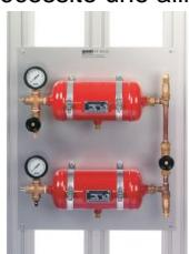
Le module de système réglé RT 450.03 est un élément prêt à monter sur plaque. Il permet, avec d'autres composants modulaires de technique de régulation, de réaliser et détudier des régulations de pression impliquant différents paramètres.
