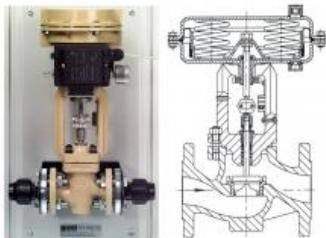
La vanne de régulation électropneumatique sert essentiellement à la réalisation d'une boucle de régulation du niveau ou du débit.
