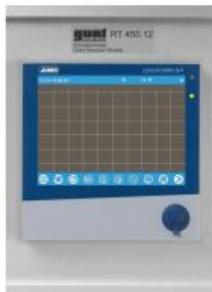
Lenregistreur sans papier est installé dorigine sur une plaque qui se fixe facilement et rapidement sur le bâti du RT 450.
