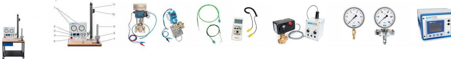
Le banc détalonnage permet d'étudier les caractéristiques de transfert des composants électriques et pneumatiques de la boucle de régulation, tels que les transducteurs de mesure et les vannes de régulation.
