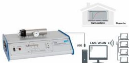
Le RT 040 propose des essais de base sur un système réglé de température.
