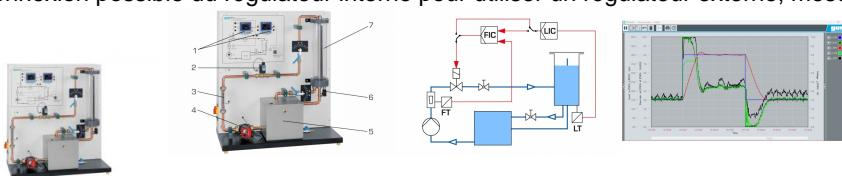
L'appareil d'essai constitue une introduction expérimentale étendue aux principes de base de la technique de régulation à l'exemple d'une régulation combinée de débit et de niveau.
