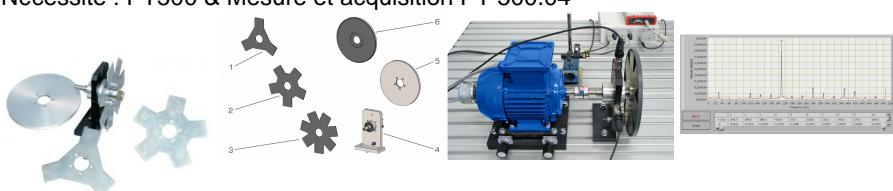
Les mesures de vibrations jouent un grand rôle pour la surveillance de fonctionnement de ventilateurs et soufflantes. En plus des signaux habituels provenant de paliers et balourds, on peut mesurer les vibrations induites par les pales. Les vibrations sont provoquées par des champs d'écoulement hétérogènes.
