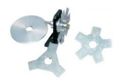
Les mesures de vibrations jouent un grand rôle pour la surveillance de fonctionnement de ventilateurs et soufflantes. En plus des signaux habituels provenant de paliers et balourds, on peut mesurer les vibrations induites par les pales. Les vibrations sont provoquées par des champs d'écoulement hétérogènes.
