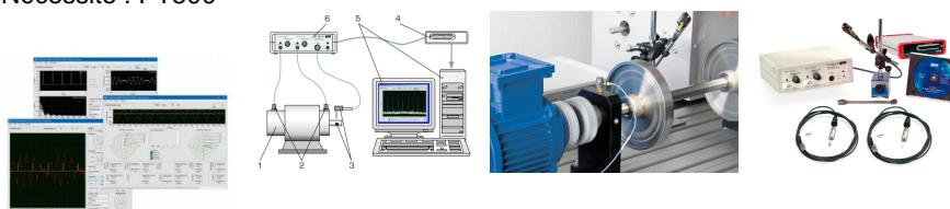
L'analyseur de vibrations assisté par ordinateur a été développé spécialement pour permettre l'interprétation des essais pour le diagnostic de machine de la série PT 500.
