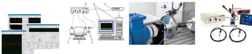
L'analyseur de vibrations assisté par ordinateur a été développé spécialement pour permettre l'interprétation des essais pour le diagnostic de machine de la série PT 500. Mais l'appareil de mesure peut également être utilisé avec profit pour de nombreux autres essais relatifs aux vibrations (p. ex. TM 150).
