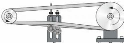
Réalisés et ajustés dans les règles de l'art, les entraînements à courroie demandent peu d'entretien, sont silencieux et à longue durée de vie. Il est important d'éviter une vibration et / ou un patinage de la courroie. Le jeu d'accessoires PT 500.14 permet d'étudier les conditions conduisant à des vibrations ou un patinage. Des courroies de tensions ajustables permettent de démontrer l'influence d'une différence d'allongement de courroies multiples.
