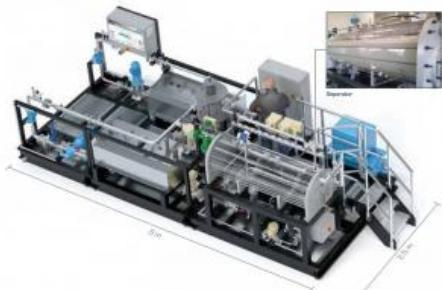
Le simulateur de séparation de phases (PST) démontre la séparation du pétrole brut simulé par de l'air, de l'eau et du pétrole.
