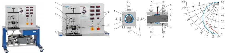
Sur les paliers hydrodynamiques, le palier et le coussinet de palier sont séparés l'un de l'autre par un film lubrifiant porteur pendant le fonctionnement.
