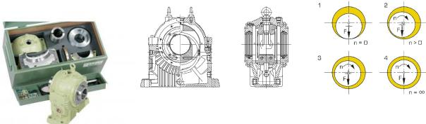
Sur les paliers lisses, un mouvement de glissement a lieu généralement entre un tourillon et un coussinet de palier. Ce mouvement de glissement est habituellement lubrifié par un fluide intermédiaire.
