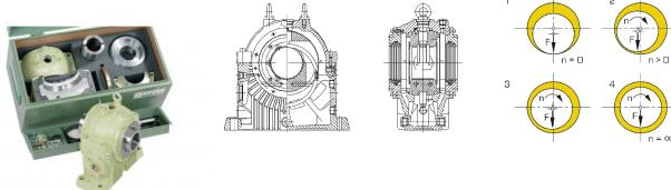
Sur les paliers lisses, un mouvement de glissement a lieu généralement entre un tourillon et un coussinet de palier. Ce mouvement de glissement est habituellement lubrifié par un fluide intermédiaire. Les paliers lisses hydrodynamiques conviennent pour un fonctionnement continu sans usure, les grands diamètres, les vitesses de rotation élevées, et les fortes charges par à-coups.
