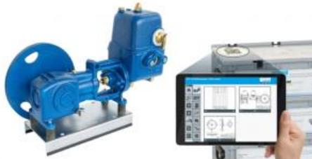
Les pompes à piston font partie des pompes volumétriques et fonctionnent par oscillation, à aspiration normale. La pompe présentée ici est une pompe à piston à double effet.
