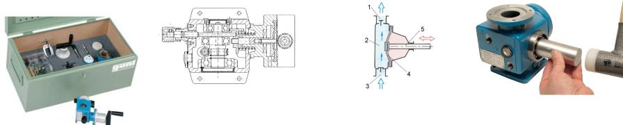
Les pompes à diaphragme font partie des pompes volumétriques et fonctionnent par oscillation, à aspiration normale.
