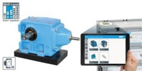
Le MT 123 traite d'un engrenage à deux étages.
