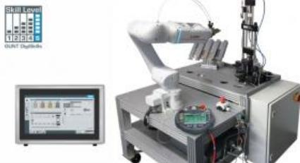
La fonction principale de l'installation dessai IA 500 est de transformer un processus manuel dans le cas présent, un essai de traction classique en un processus entièrement automatisé.
