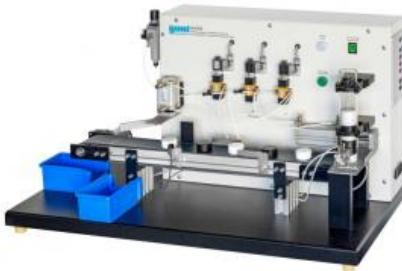
Le dispositif IA 210 est un appareil didactique et d'expérimentation compact pour la commande d'un processus de manipulation de matériel à l'aide d'un API.
