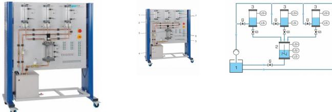
Ce banc dessai pour applications API permet de réaliser des fonctions complexes de commande dans le domaine du génie des procédés, et en particulier des opérations discontinues de dosage et de mélange.
